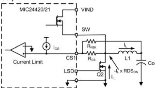
Figure 9a. Short Circuit Protection
